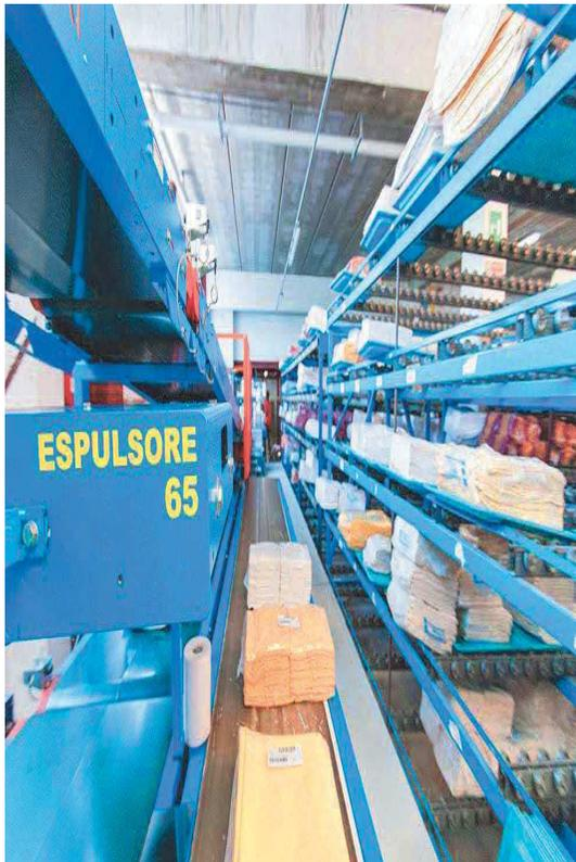
El almacén dinámico está equipado con una serie de transportadores de rodillos específicamente diseñados y guarda la ropa blanca empaquetada, que previamente se ha almacenado de forma manual o automática, en espera del reparto de los clientes.
