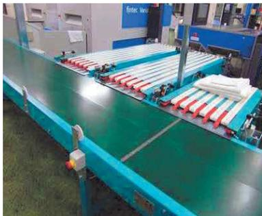
Proyectamos y construimos sistemas de traslado mediante cinta que se colocan a la salida de las calandras.
