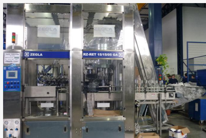
Fig. 06: Monoblock presurizado especialmente diseñado para un envasado aséptico
